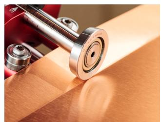
Faites glisser la plieuse le long du bord du matériau, en soulevant légèrement la poignée dans le sens du pli pour amorcer une ligne de pliage. Le pli initial formé à cet endroit est essentiel pour définir la trajectoire que suivra la plieuse.
