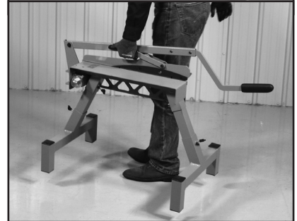
6. Setzen Sie den Querbolzen für den Transport des Werkzeugs wieder ein, um den Griff und die Klinge an Ort und Stelle zu arretieren.
