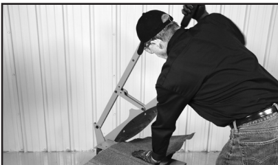
1. Rimuovere il perno trasversale che blocca il gruppo della maniglia e lama. Mettere da parte il perno per uso futuro.
