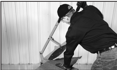
1. Entfernen Sie den Querbolzen, der die Griff-Klingen-Baugruppe arretiert. Bewahren Sie den Bolzen zur späteren Wiederverwendung auf.
