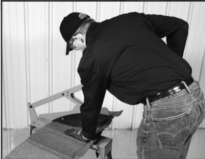
4. Ziehen Sie den Griff herunter, um einen Schnitt zu setzen.
