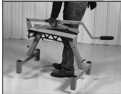
6. Pour le transport de l'outil, remettre la goupille pour bloquer le manche et la lame en place.
