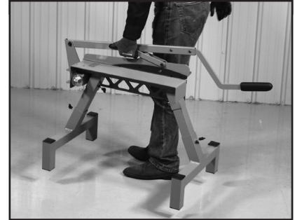
6. Para transportar la herramienta, vuelva a colocar el pasador transversal para bloquear el mango y la cuchilla.
