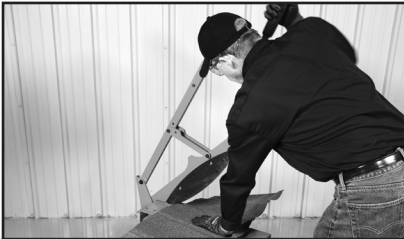
1. Retire el pasador transversal que bloquea el conjunto del mango y la cuchilla. Conserve el pasador para posteriores usos.
