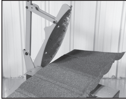
2. Levante el mango para abrir la garganta de la herramienta.
