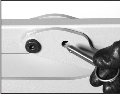
1. Retire el pasador transversal que bloquea el conjunto del mango y la cuchilla. Conserve el pasador para posteriores usos.
